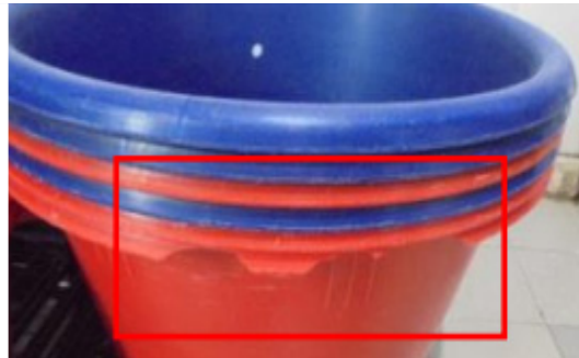
[플라스틱 용기 파손]
