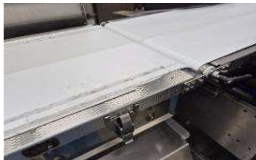
[컨베이어 벨트 파손]
